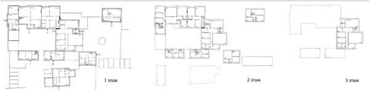
Рисунок 4. Hazells Hall. Схемы перепланировки этажей.. Толстая заливка показывает новые перегородки<sup>9</sup>.
